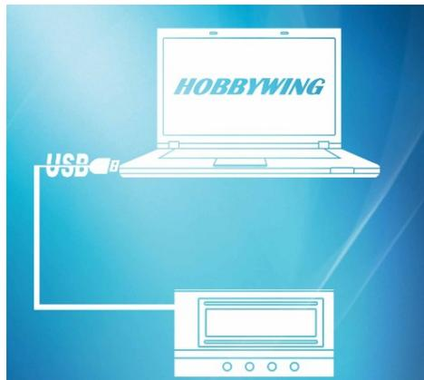
情况二、如果要对电调进行参数设置或升级, 则还要将电调的BEC 排线(控制线) 插到设定盒上的“ESC” 接口中(白线靠近缺口一侧), 将电调接上电池, 然后打开电调开关. 详细接线步骤如下:
